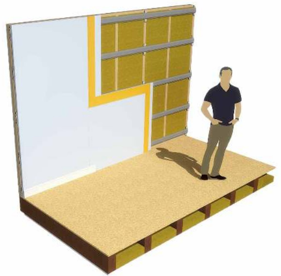
Stud Wall Build Up
